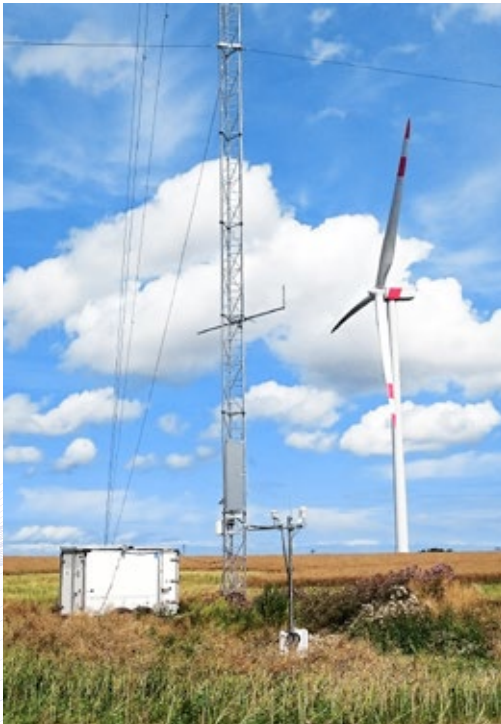
► Versuchsfeld in Brusow mit Windenergieanlage eno114005 und Messmast im Hintergrund, atmosphärischer Messstation und Lidar-System zur Anströmmessung (weißer Anhänger) im Vordergrund
